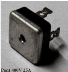
Pont 400V 25A
